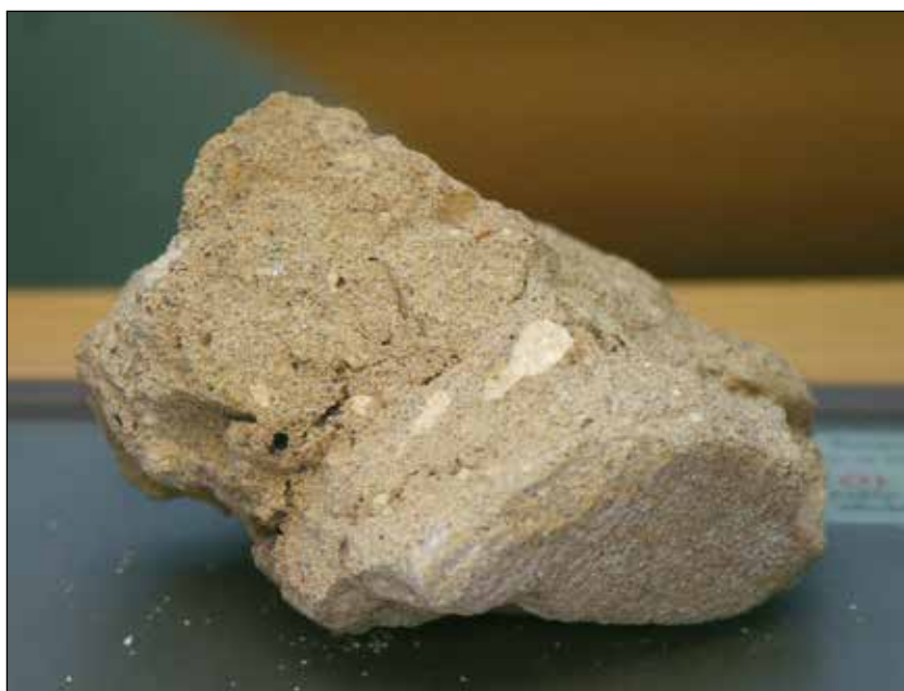
400 år gammalt murbruk med smärre kalkklumpar och träkolsfragment.
